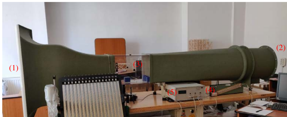
(1) Intrare aer, (2) Ieșire aer, (3) Macheta, (4) Anemometru și barometru digital, (5) Afișaj Fig. 3.23. Tunelul de vânt deschis Gunt HM 170
